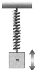
a) Com uma massa  $m$  suspensa, a mola oscila em torno da posição de equilíbrio (obtida de  $mg = ky_0$ , isto é  $y_0 = \frac{mg}{k}$ ) com frequência angular dada por  $\omega = \sqrt{\frac{k}{m}}$ , em que  $k$  é a constante da mola. O período é, portanto,  $T = \frac{2\pi}{\omega} = \frac{2\pi}{\sqrt{k/m}}$ . A constante da mola obtem-se a partir desta última relação:
